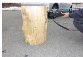
写真-3 穿孔抵抗試験 (サンプルヒバ)
